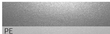
PE – шагрень. Поверхность имеющая небольшую шероховатость.
